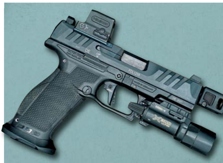
Wohl die wenigsten kommen bei uns in den Genuss, auf dem 1/2"-28 UNEF-Gewinde einen Schalldämpfer nutzen zu können. Alternativ würde aber auch ein Kompensator gehen, wie dieser von Petersen Gunworks aus Münster.
