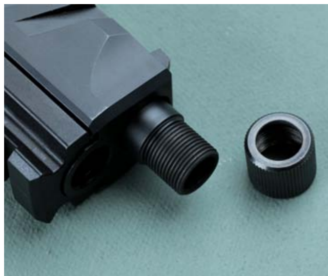
Wohl die wenigsten kommen bei uns in den Genuss, auf dem 1/2"-28 UNEF-Gewinde einen Schalldämpfer nutzen zu können. Alternativ würde aber auch ein Kompensator gehen, wie dieser von Petersen Gunworks aus Münster.
