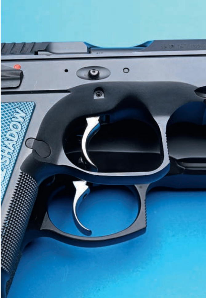
Der nun eckiger gestaltete Abzugsbügel wurde am Übergang zur Griffstückfront progressiver ausgekehlt.
