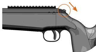
Durch das Spannen aktiviert sich die Sicherung automatisch und die Waffe kann nicht geschossen werden. Drücken Sie zum Entsichern die Sicherung nach unten, so dass der Warnpunkt erscheint. Die Waffe ist jetzt schussbereit.
