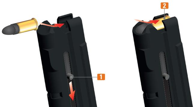
1. Tire el botón de alimentación del cargador hacia abajo **1** e inserte el cartucho **2** (como se muestra en la figura) hasta el tope trasero.
