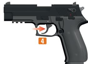
1. Mettez le levier de sûreté dans la position « prêt au tir ». Visez dans une direction sûre et actionnez la détente **4**.
