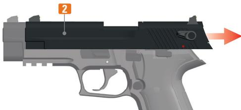
2. Tirez la glissière **2** vers l'arrière jusqu'à la butée, puis faites-la regliser en avant. **Note:** Le pistolet est maintenant chargé et prêt à tirer en mode simple action (état armé).
