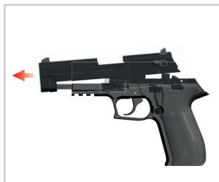
5. Poussez l'assemblage de glissière vers l'avant lentement, en le faisant passer par-dessus la bouche de l'arme.
