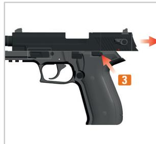
2. Tirez la glissière vers l'arrière jusqu'à la butée, puis poussez le levier d'arrêt de glissière **3** pour retenir la glissière en position arrière.
