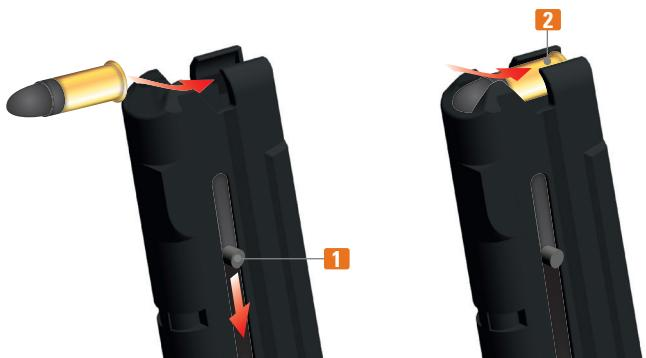
1. Zubringerknopf des Magazins nach unten ziehen **1** und die Patrone **2** wie abgebildet bis zum hintereren Anschlag einschieben.
