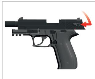
3. Drücken Sie den Schlitten am Ende nach unten, bis er in das Griffstück einrastet. Schieben Sie den Schlitten dann vorsichtig nach vorn, bis er vollständig geschlossen ist.
