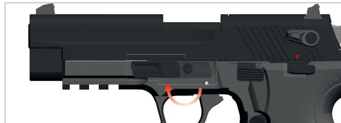
2. Drehen Sie den Demontagehebel im Uhrzeigersinn, bis er nach vorn zeigt (180°)
