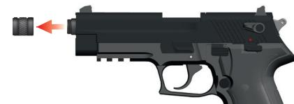
1. Entfernen Sie die Gewindekappe (nur Modell GSG firefly SD).
