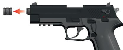
1. Retire el tapón roscado (sólo válido para el modelo SD).
