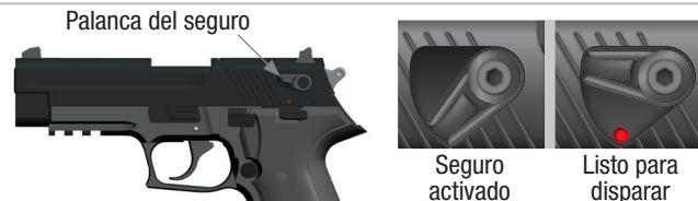
1. Seguridad manual: Palanca de seguridad
