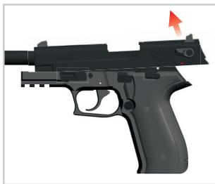
4. Heben Sie das Ende des Schlittens leicht an.
