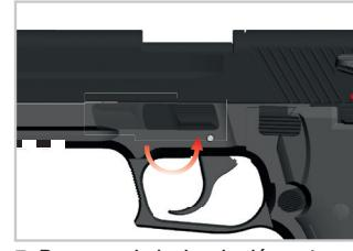
5. Ramenez le levier de démontage à sa position initiale (faites tourner le levier vers l'arrière de 180°). Réinstallez le bouchon fileté (valable pour le modèle SD seulement).
