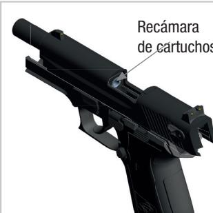
1. Active el seguro del arma y pulse el botón de retenida del cargador **2** para retirar el cargador. Después de disparar el último cartucho, la corredera debe ser mantenida en la posición trasera. Compruebe (visual y manualmente con dispositivos de ayuda adecuados) que el cartucho ha sido expulsado y asegúrese de que la recámara esté realmente vacía.
