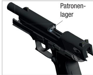
3. Ziehen Sie den Schlitten bis zum Anschlag zurück, dabei wird die Patrone ausgeworfen. Überprüfen Sie (sowohl visuell als auch manuell mit entsprechenden Hilfsmitteln), dass die Patrone tatsächlich ausgeworfen wurde und das Patronenlager leer ist.
