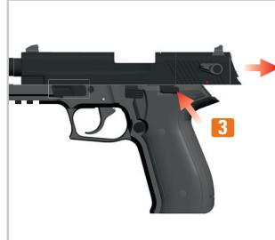
2. Ziehen Sie den Schlitten zurück und drücken den Schlittenfanghebel **3** nach oben um den Schlitten in der hinteren Position zu halten.
