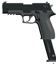
1. Introduzca el cargador descargado **1** y asegúrese de que se haya encajado completamente.
