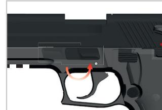
5. Vuelva la palanca de desmontaje a su posición original (gírela hacia atrás 180°). Reinstale el tapón roscado (sólo válido para el modelo SD).
