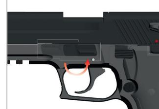
5. Drehen Sie den Demontagehebel zurück (180°). Schrauben Sie die Gewindekappe wieder auf die Waffe (nur Modell GSG firefly SD).
