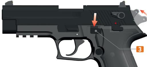
3. La pistola puede ahora ser desamartillada mediante la palanca de desamartillado **3**. La pistola está entonces cargada, desamartillada y lista para disparar en modo de doble acción (posición de desamartillado).
