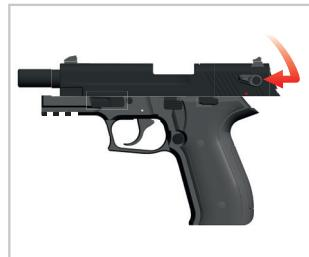
3. Poussez la glissière vers le bas jusqu'à ce que le guide de la glissière s'enclenche dans le guide de la carcasse. Faites doucement avancer la glissière jusqu'à ce qu'elle soit fermée.
