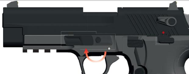
2. Gire la palanca de desmontaje en el sentido de las manecillas del reloj hasta que la palanca esté orientada hacia adelante (180°).
