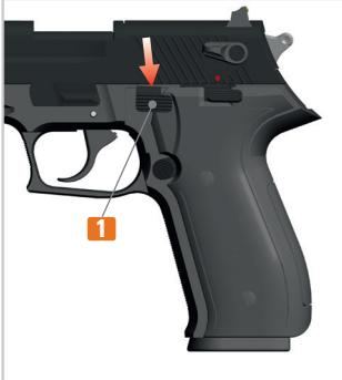
1. Active el seguro del arma. Empuje la palanca de desamartillado **1** para desamartillar el martillo.
