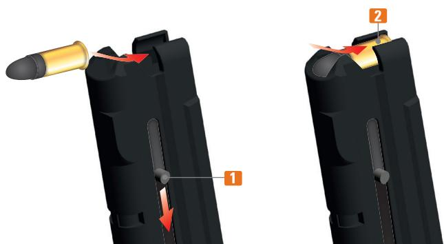
1. Tirez le bouton d'alimentation du magasin vers le bas **1** et insérez la cartouche **2** (comme montré dans la figure) jusqu'à la butée arrière.
