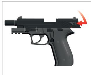
3. Empuje la corredera hacia abajo para que la guía de la corredera pueda encajar en la guía de la armadura. Haga avanzar la corredera suavemente hasta que ésta esté cerrada.
