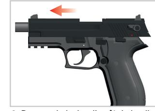
4. Poussez le levier d'arrêt de la glissière pour ainsi ramener la glissière jusqu'à la bouche du canon de l'arme.
