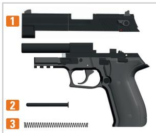
6. Entfernen Sie die Schlittenbaugruppe (Schlitten **1**, Federführung **2**, Schließfeder **3**).
