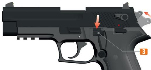
3. Le pistolet peut alors être désarmé au moyen du levier de désarmement **3**. Le pistolet est alors chargé, désarmé et prêt à tirer en mode double action (état désarmé).
