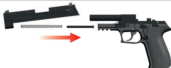
1. Réinsérez la tige guide du ressort récupérateur, le ressort récupérateur et la glissière (en suivant l'ordre indiqué dans la figure).
