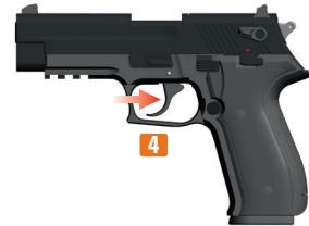
1. Ponga la palanca del seguro en la posición "seguro desactivado". El arma está ahora desasegurada y lista para disparar. Apunte en una dirección segura y accione el gatillo **4**.
