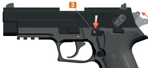
3. El arma puede desamartillarse tras los tiros en seco (Dry-Fire) con la palanca de amartillado **3**. En ese caso, se encontrará descargada, desamartillada y asegurada.
