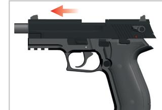
4. Presione la palanca de retención de la corredera para hacer deslizar la corredera hasta llegar a la boca del cañón del arma.
