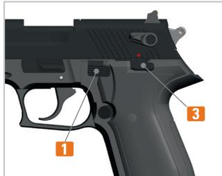
4. Empuje la palanca de retención de la corredera **3** y haga deslizar la corredera de nuevo hacia adelante. Desamartille el martillo presionando la palanca de desamartillado **1**.
