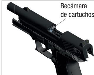
3. Tire la corredera hacia atrás hasta el tope. Manténgala en esta posición hasta que el cartucho sea expulsado. Compruebe (visual y manualmente con dispositivos de ayuda adecuados) que el cartucho ha sido expulsado y asegúrese de que la recámara esté realmente vacía. Haga deslizar la palanca de amartillado de nuevo hacia adelante.
